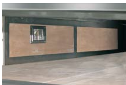
wnętrze komory wyłożone materiałem ogniotrwałym
